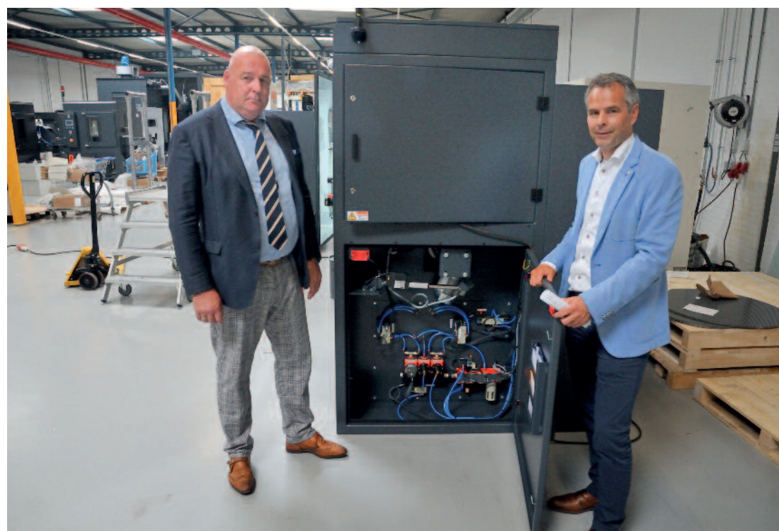
Freek van der Waardt van Metal Work (links) en André Zoetewij van Leering tonen de besturingstechnologie in een van de straalmachines. De technologie van Metal Work is herkenbaar aan de feloranje kleur. Foto: Com-magz
