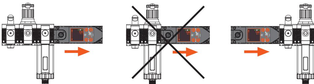
Dal lato di uscita del FLUX i componenti Syntesi® possono essere montati liberamente.
