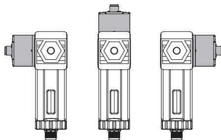
**N.B.:** Qualora il FLUX venga utilizzato dopo un filtro Syntesi®, deve essere montato in una delle tre posizioni indicate a figura.
