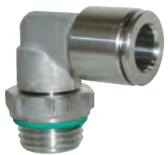
Raccordi automatici in acciaio inossidabile AISI 316, tubi da Ø 4 a 12 mm, filetti da M5 a 1/2"
