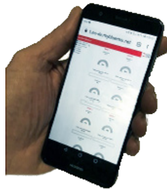
Figure 7: Possibilité de vérifier à distance les données de chaque électrodistributeur et vérin.
