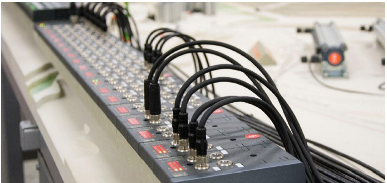
Рисунок 4: EB80 управляет исполнительными механизмами и датчиками в аналоговом и цифровом режимах.
