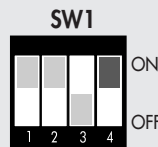
Resistenza di terminazione inserita Terminating resistance activated
